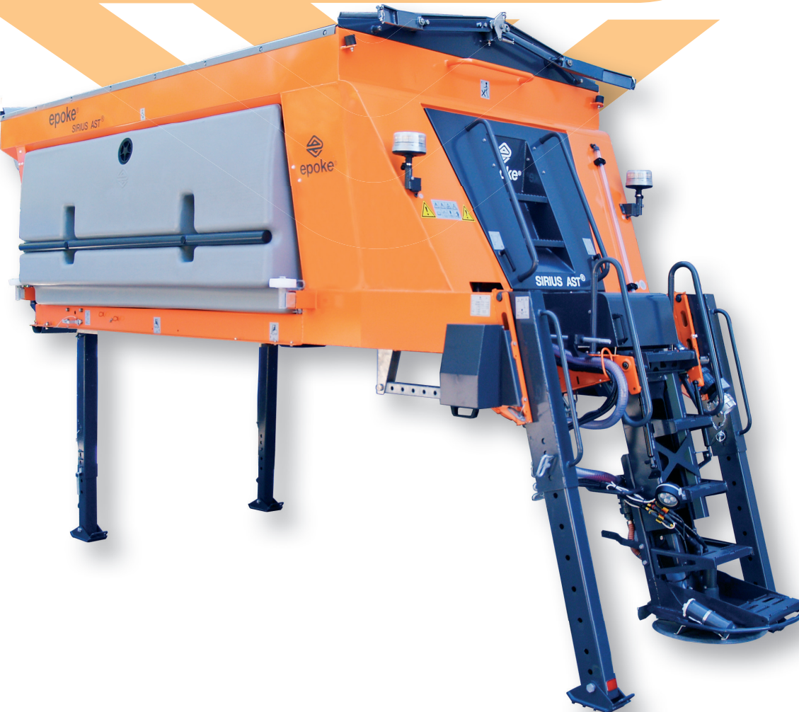
Betjeningsvenlig opklapbar presenning med lås og 100% beholderåbning
